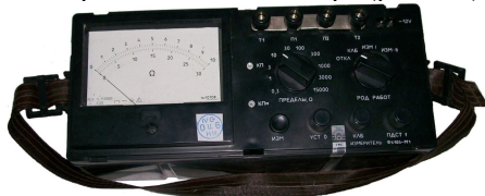
Рис. 4.4. Измеритель сопротивления заземления типа Ф4103-М1 Результаты измерений и вычислений занести в таблицу 4.1:
