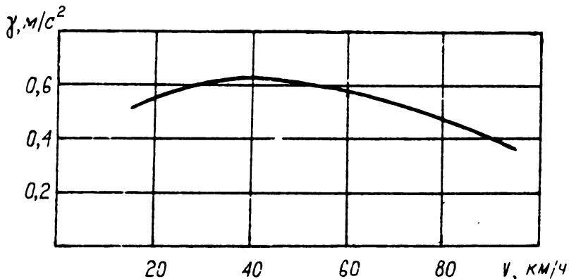
Рисунок 3.2. График ускорения автомобиля на одной передаче
