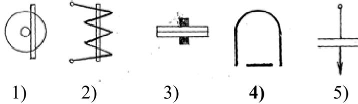
2. Прибор какой системы можно использовать для измерения напряжения, тока и мощности в цепях постоянного и переменного тока?
