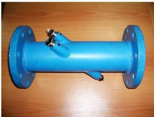
Рисунок 7.15- Двухлучевой ультразвуковой расходомер
