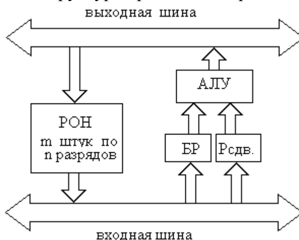
Рисунок 7.3 – Обрабатывающая часть МП без управляющих цепей
