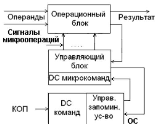
Рисунок 7.9 – Схема микропрограммного управления
