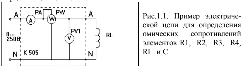
Рис. 1.1. Схема для измерения сопротивления по показаниям амперметра, вольтметра и ваттметра
