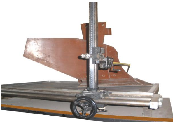
Рисунок 3.2 – Положение корпуса на координатомере
