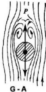
Рис. 2.1. Силы, действующие на твердую частицу в направленном вверх потоке
