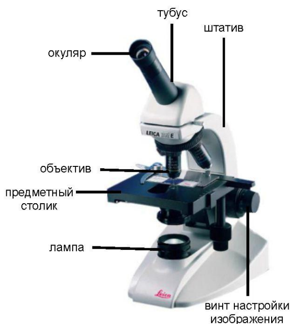
Рис. 3 - Составные части микроскопа
