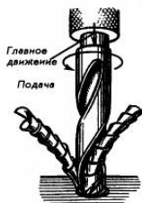
Рисунок 2.1 – Процесс сверления
