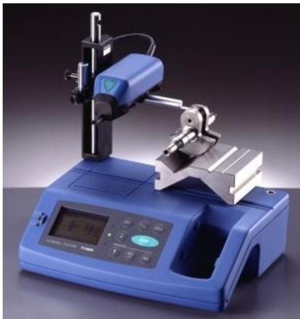
*Прибор для мобильного и стационарного измерения шероховатости поверхности*
