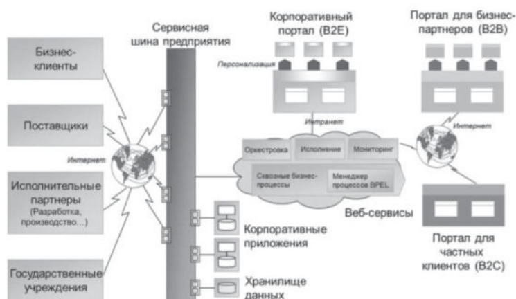
Рисунок 3. Иллюстрационная структура сервис-ориентированной архитектуры (COA)
